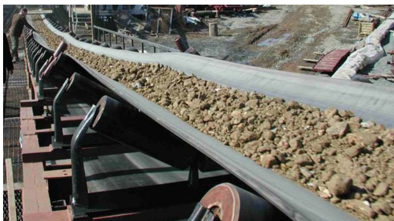
Из этой руды будет извлечено золото методом кучного выщелачивания. месторождение «Воронцовское»
